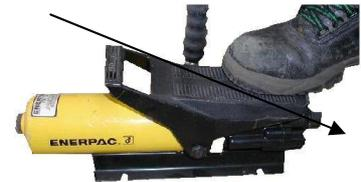
Anstelle der Fusspumpe kann die Stanze auch mit einer hydraulischen Druckhandpumpe bedient werden.
